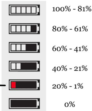
Wenn die Akkuladung gering ist, wird der letzte Strich **Rot** angezeigt & wird die Unterstützung **reduziert**, um die Reichweite zu erhöhen.
